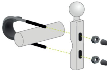
2. Befestigen Sie den Sockel an der Halterung und verbinden Sie die Kabel mit dem Bordnetz Ihres Motorrads.
