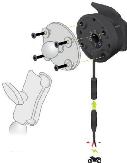
**Wichtig:** Der rote Plusleiter (+) muss am Kabelstrang des Motorrads an einer Stelle zwischen der Motorradzündung und dem Pluspol der 12-V-Motorradbatterie angeschlossen werden. Der schwarze Minusleiter (-) muss am Kabelstrang des Motorrads an einer Stelle zwischen der Motorradzündung und dem Minuspol (Masse) der Motorradbatterie angeschlossen werden. Führen Sie die Befestigung an einem 12-Volt-Punkt durch, der wie der Lichtkreis von der Zündung ausgeschaltet werden kann.
