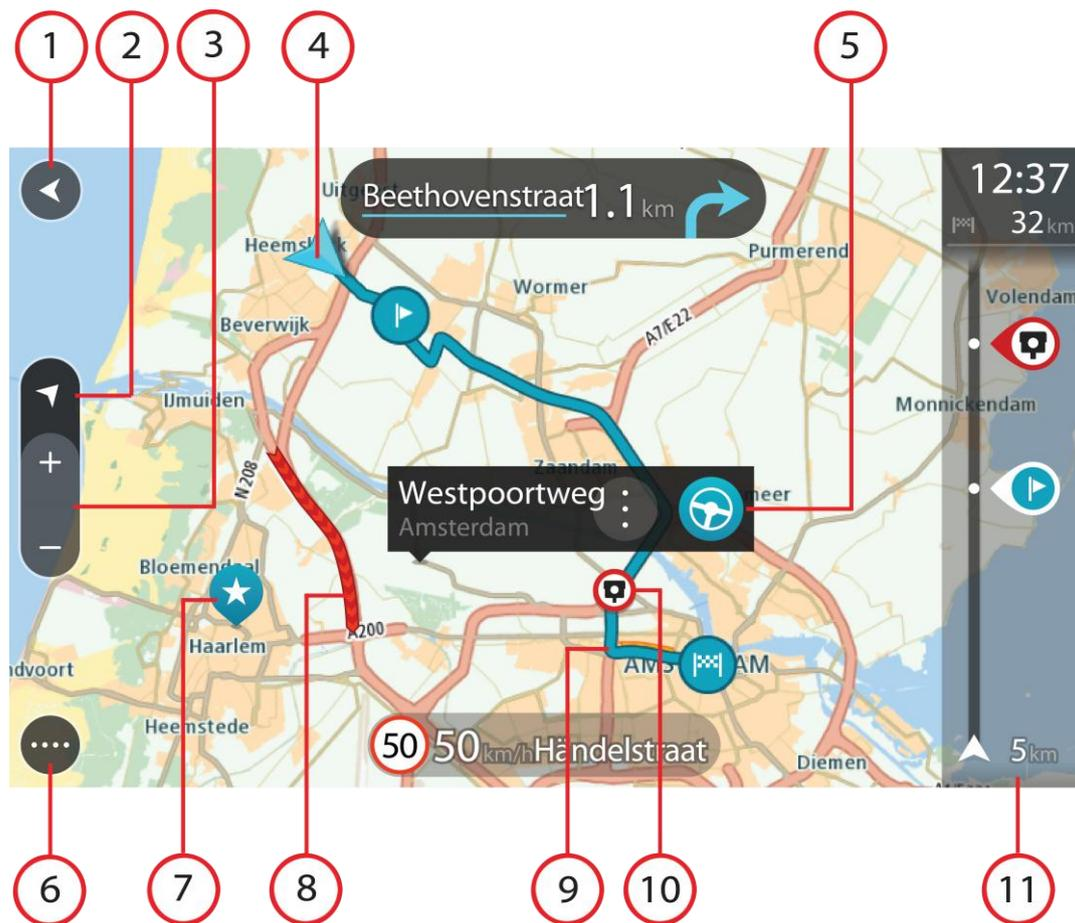
1. Taste „Zurück“: Diese Taste bringt Sie von der Karte aus zu einer Übersicht der gesamten Route oder verschiebt die Karte so, dass sich Ihre aktuelle Position in der Mitte befindet, wenn keine Route geplant ist.
